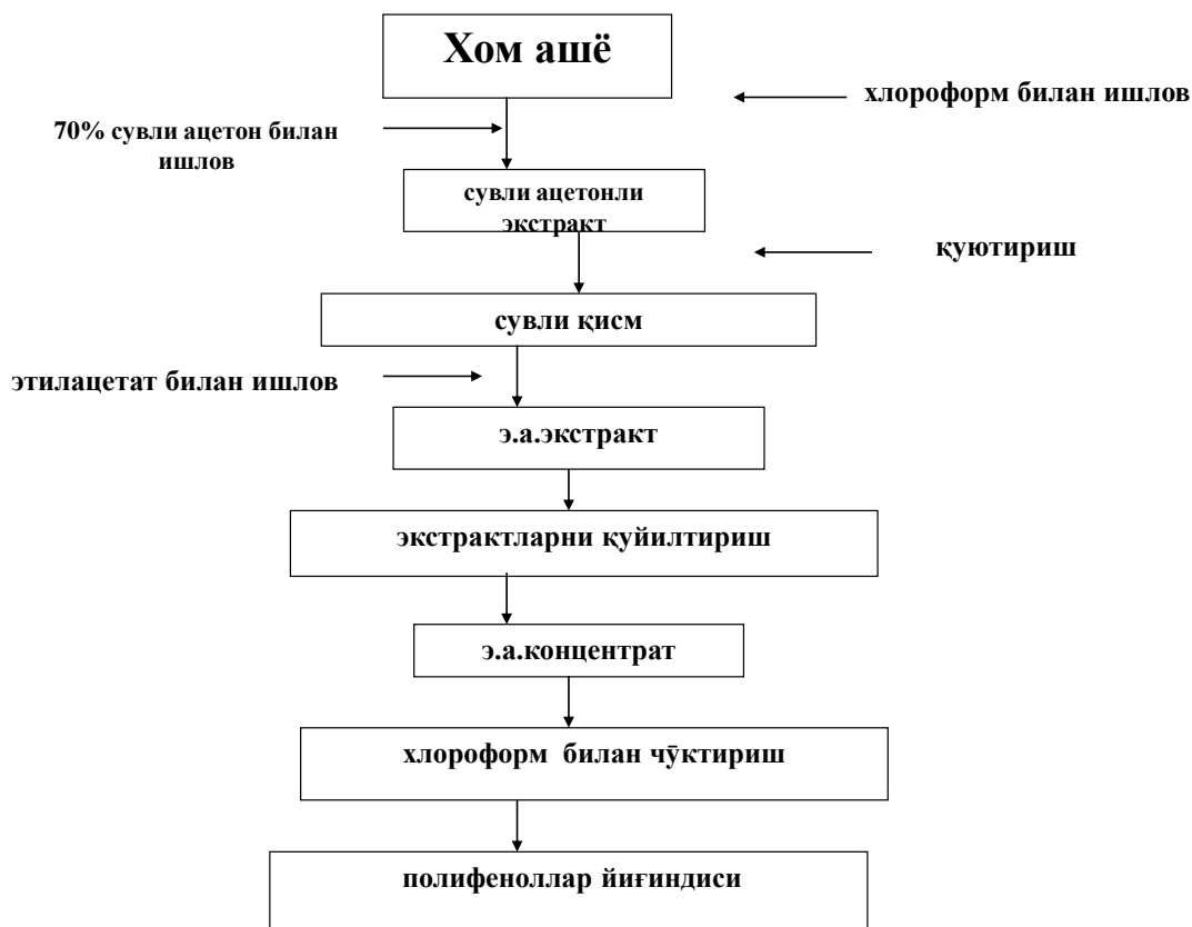
1-схема. Hippophae rhamnoides L ўсимлиги ер устки қисмидан полифеноллар йиғиндисини ажаритб олиш схемаси.
