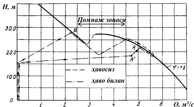
4 – расм. Босим қувирида тескари клапан билан жиҳозланган ОПВЗ -110 насосини ишга туширишда режим нуқтасининг ҳаракати
