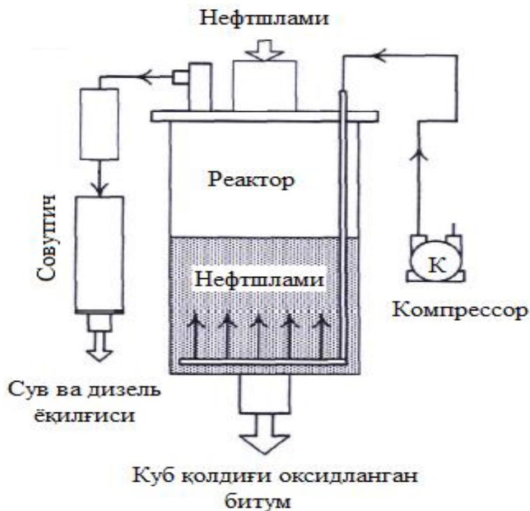
1-расм. Нефтшламини қайта ишлаш схемаси
