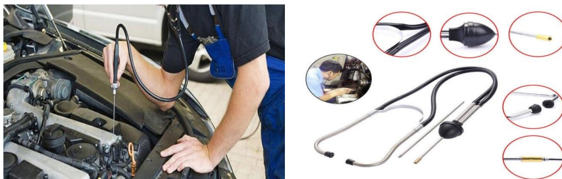
Рисунок 2. Устройство диагностики автомобильного шума - стетоскопом.
