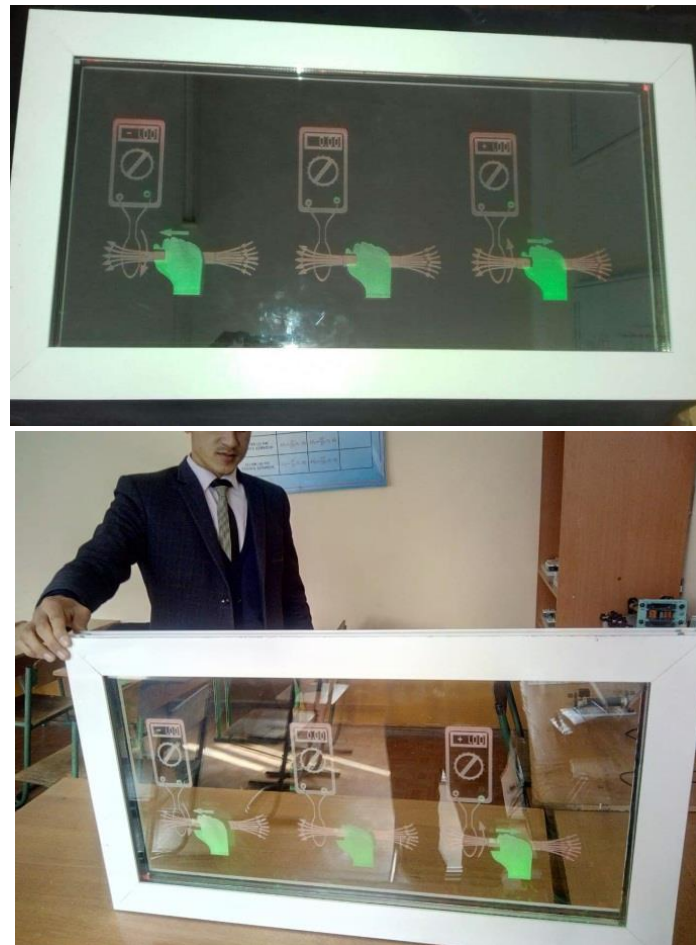
2-rasm. Faradey tajribasini namoyish qiluvchi optik qurilma.
