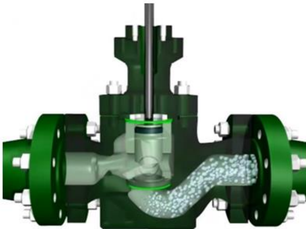
1-расм. Насос қурилмаларида кавитация ходисасининг кўриниши.
