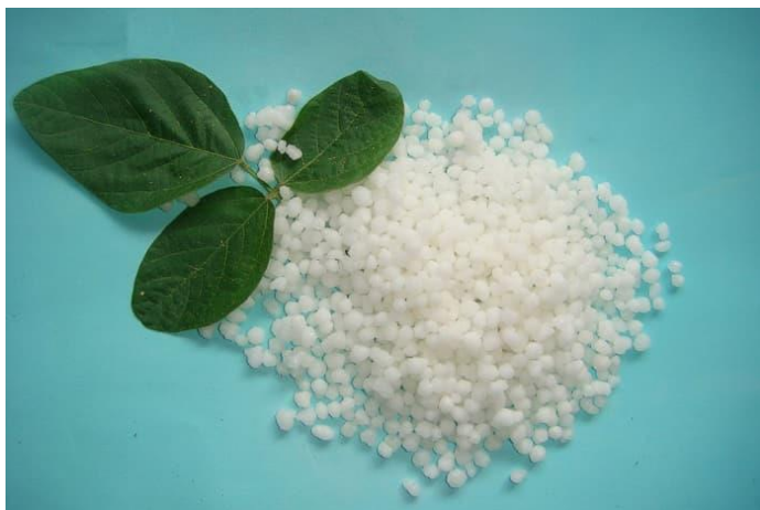
rasm 2. Ammoniy nitrat yoki ammoniyli selitra. Oq kristall modda. Sanoatda portlovchi modda va minerall o'g'it sifatida ishlatiladi.
