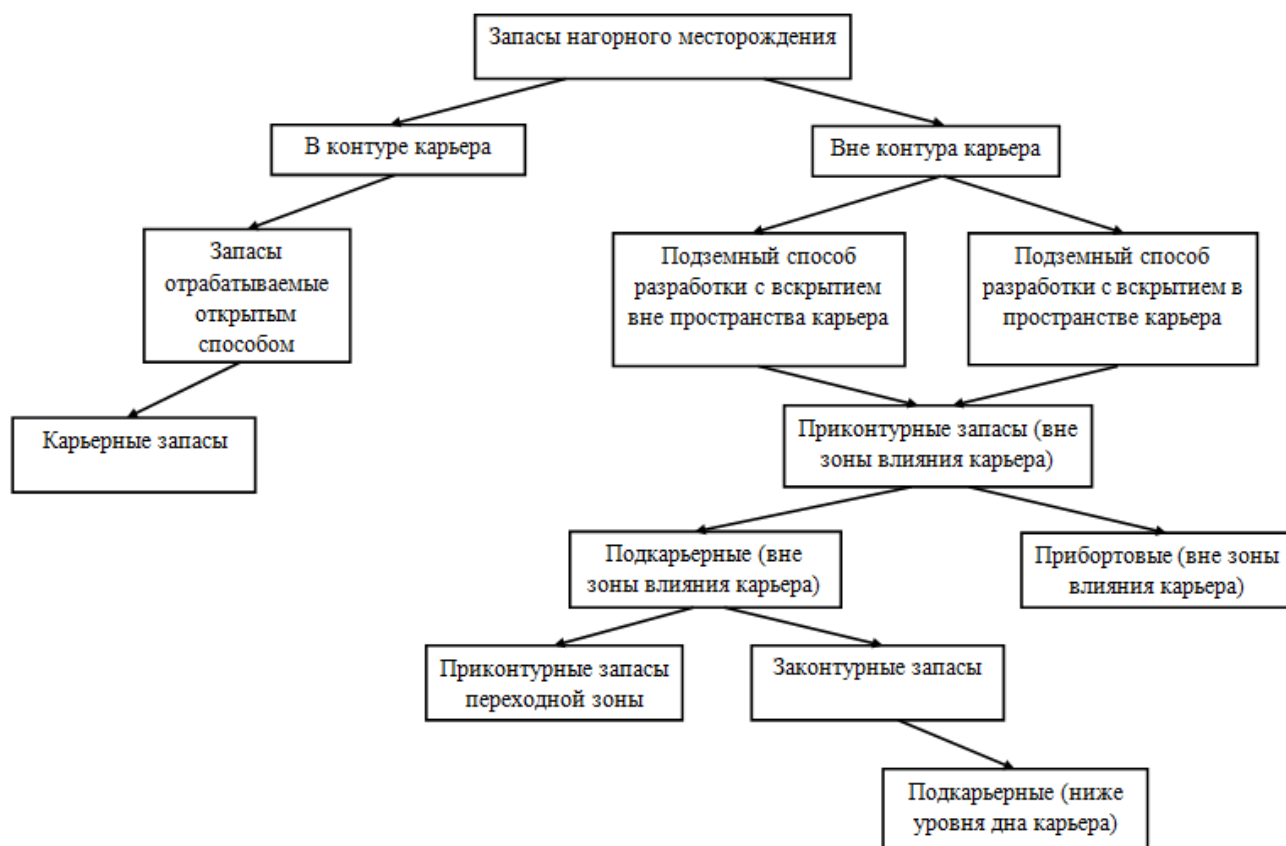
Рисунок. 2. Разработанная классификация отработке запасов нагорных месторождений открыто-подземным способом
