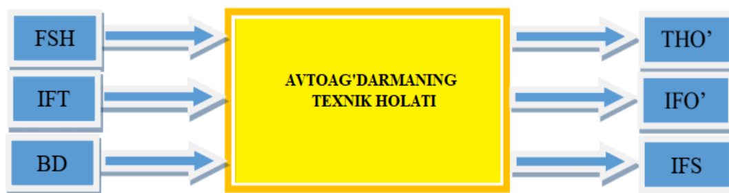
2-rasm. Karyer avtoag'darmalarining texnik holatini belgilovchi omillarning asosiy guruhlari: FSH – foydalanish sharoitlari; IF- ishlash faoliyati tartibi; BD – boshqaruv darajasi /kasbiy tayyorgarlik, malaka/ avtoag'darma mashinisti; THO' – texnik holat o'lchamlari; IFO' – ishlash faoliyati o'lchamlari; IFS – ishlash faoliyati samaradorligi.
