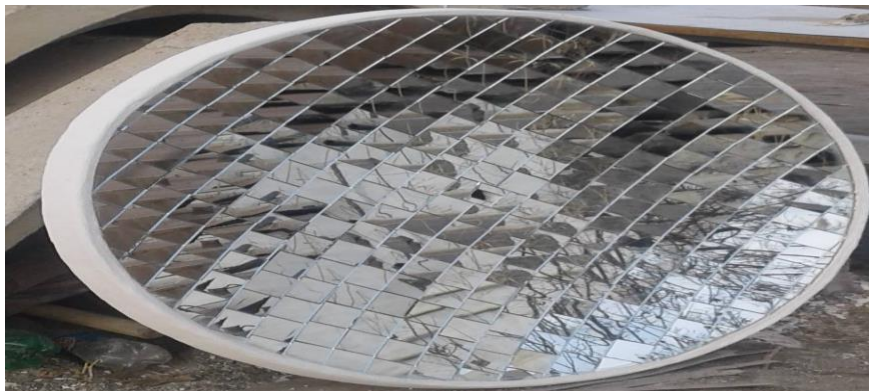
8-rasm. Sirti 5x5 sm o'lchamdagi ko'ngular bilan qoplangan paraboloidning haqiqiy ko'rinishi.
