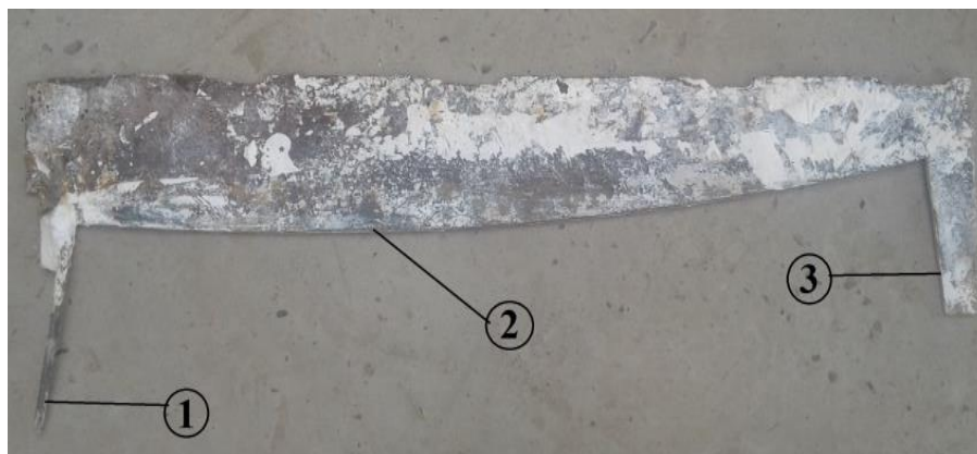
5-rasm.Parabola shakldagi qolibning haqiqiy ko'rinishi. 1. Qolibning o'qi (parabola o'qi), 2.parabola shakli, 3. Qolibning tayanch qismi.
