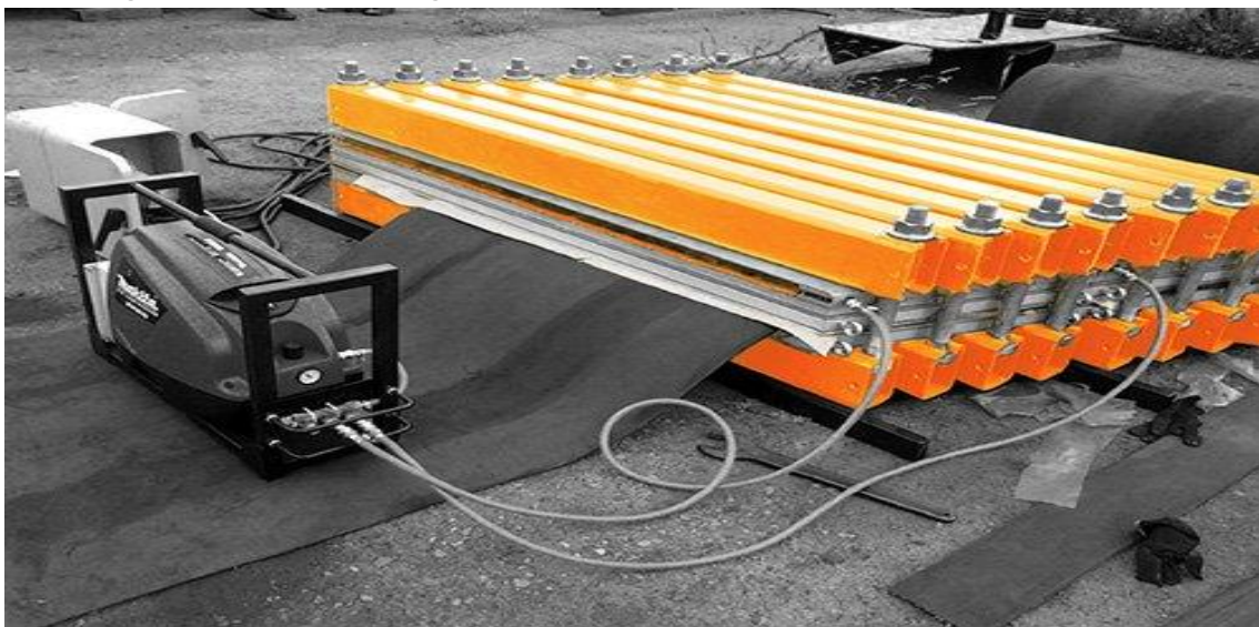
3-rasm. Konveyr tasmasi uchun issiq vulkanizatsiya yordamida ulash
